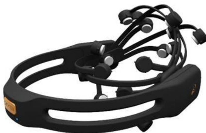
Fig. 5.18: Interface Cérebro Computador da EMOTIV
