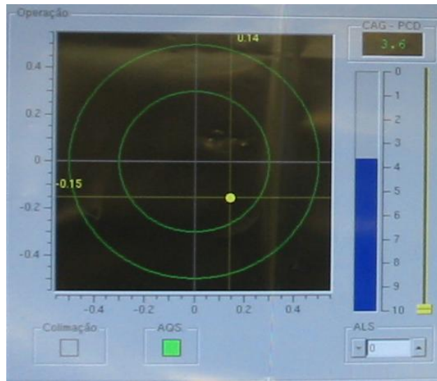
Fig. 5.28: Foto: Omnisys Engenharia . Scope do Radar de Telemidas Redundante indicando o desvio em azimute e elevação.
