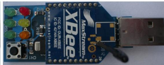
(b) Placa e Módulo XBee
