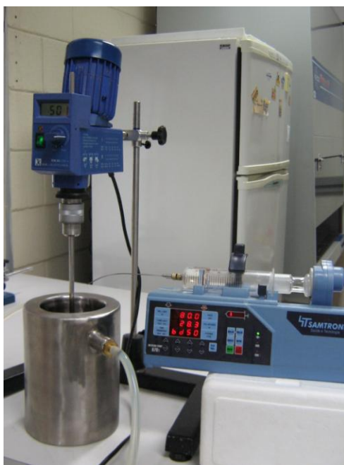
Figura 3.1: Sistema utilizado na preparação da mistura polimérica formadora das membranas
