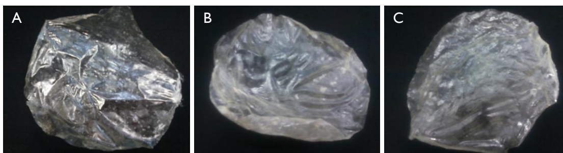
Figura 4.1: Membranas obtidas com aumento de escala: (A) 80ml/h, (B) 120ml/h, (C) 160ml/h.
