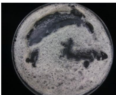
Figura 4.19: Membrana com Pluronic F68 obtida sem a etapa de desaeração (material submetido a repouso antes de ser colocado na estufa).
