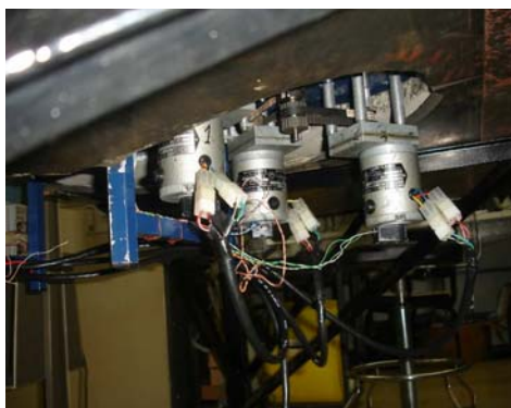
Fig. A.2: Motores acoplados à estrutura mecânica do robô.
