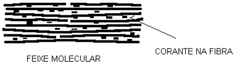
Figura 17. Penetração do corante no interior da fibra
