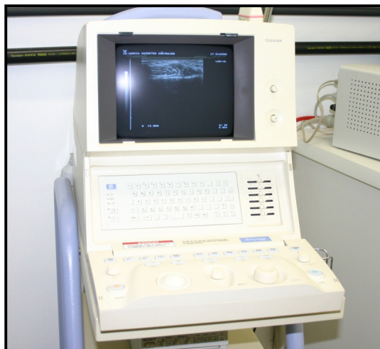
Figura 8: Equipamento de ultra-som digital Just Vision 200, da Toshiba Corporation, Japão
