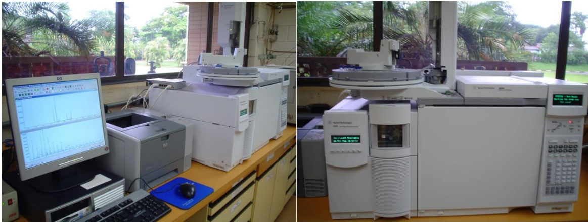
Figura 16- Foto ilustrativa do equipamento utilizado na análise qualitativa CG/EM (HP6890/HP5975).
