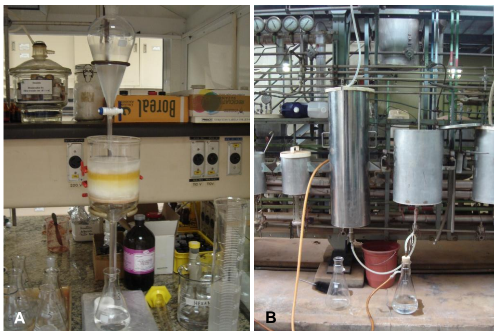
Figura 14- Foto ilustrativa de coluna cromatográfica filtrante em escala laboratorial (A) e piloto (B).
