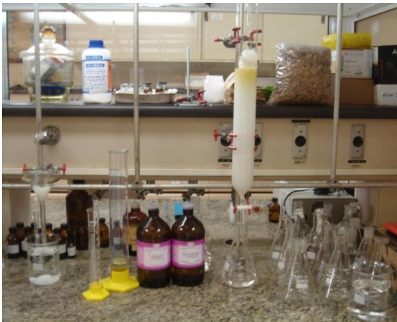
Figura 15- Foto ilustrativa de montagem de coluna cromatográfica clássica.
