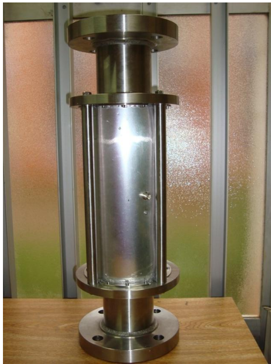
Fig. 2.3 Uma sonda capacitiva.
