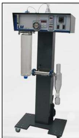
Figura 3.2 - Mini spray dryer MSD 1.0 Labmaq do Brasil Ltda.
