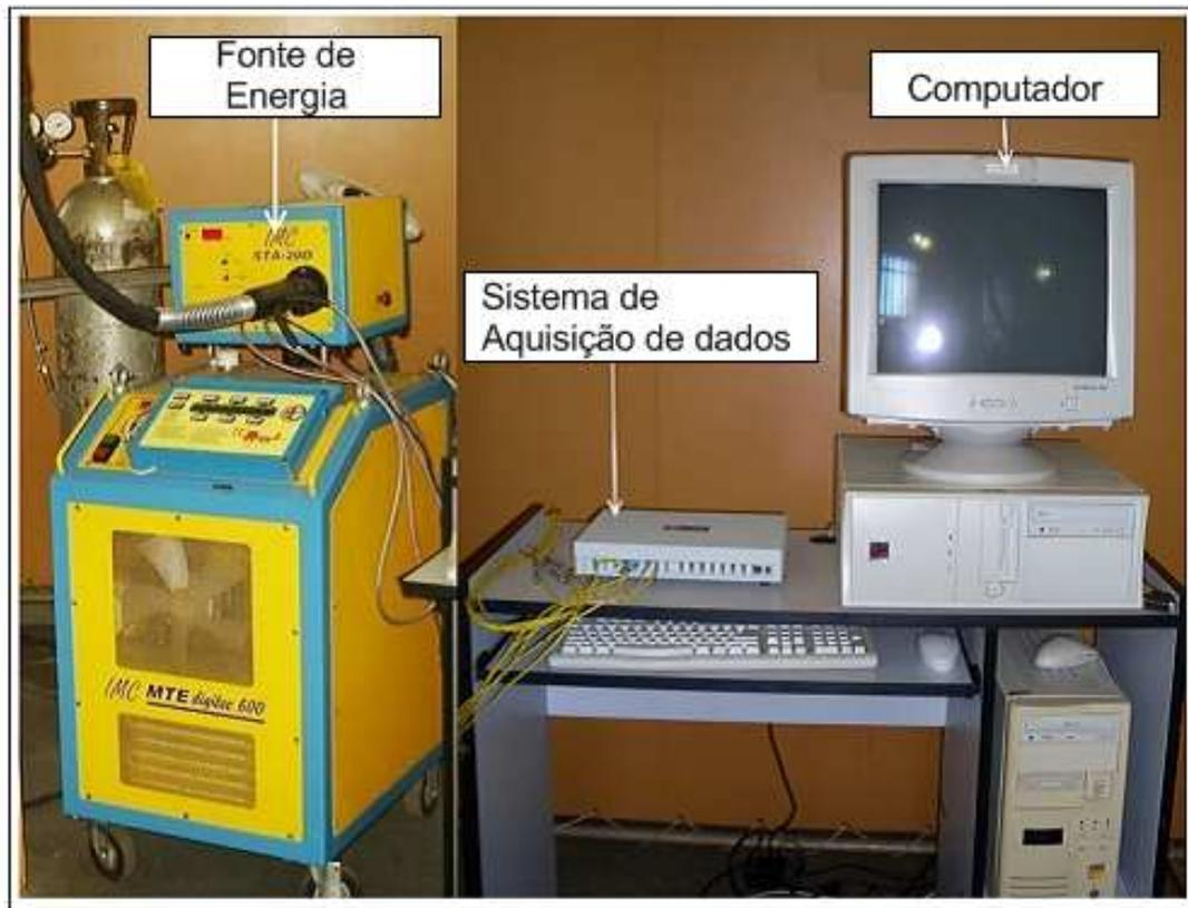
**Figura 3.1** – Fonte de Energia e sistema de aquisição de dados.
