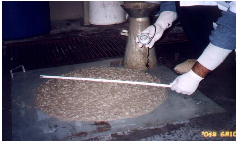
Figura 4.2 – Ensaio de Espalhamento em concreto auto-adensável.
