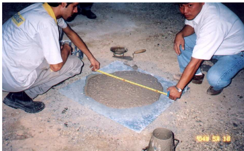
Figura 4.7 – Ensaio em campo de espalhamento do CAA (650 x640) mm. Fonte: MC Bauchemie Brasil / Concrebase
