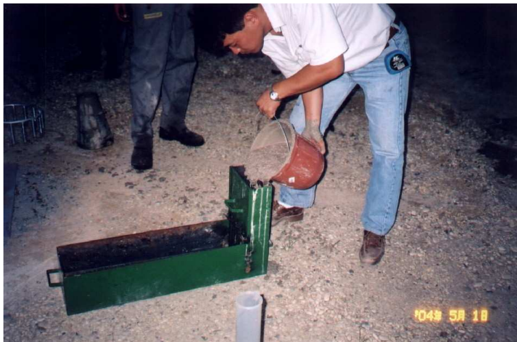
Figura 4.9 – Ensaio de fluidez com a caixa L em campo. Fonte: MC Bauchemie Brasil / Concrebase.
