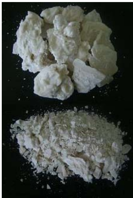
Figura IV.4 – Amostra quebradiça obtida no primeiro ensaio preliminar.
