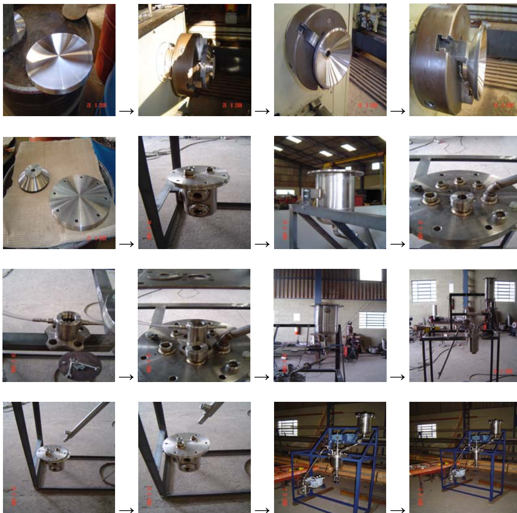
Figura IV.1 – Fluxograma simplificado da construção da Unidade Experimental.
