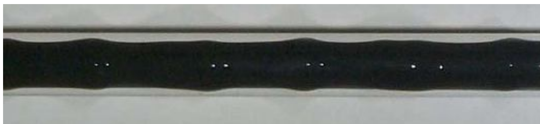
Figura 2.1- Escoamento horizontal core-flow .
