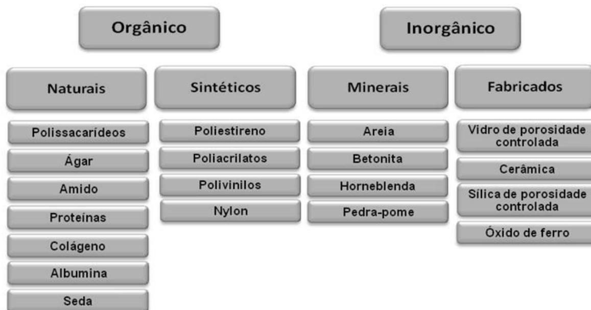
**Figura 8.** Classificação dos suportes para imobilização de enzima quando a sua composição. **Fonte:** (MESSING, 1975).
