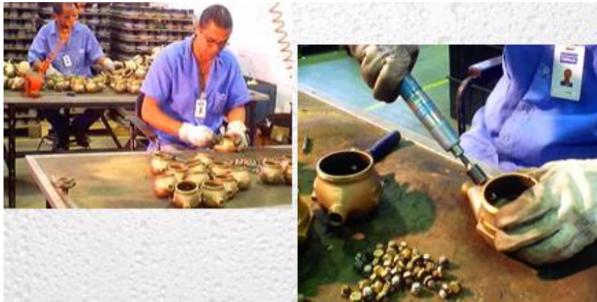
Figura 4.23: Rebarbação manual de carcaças
