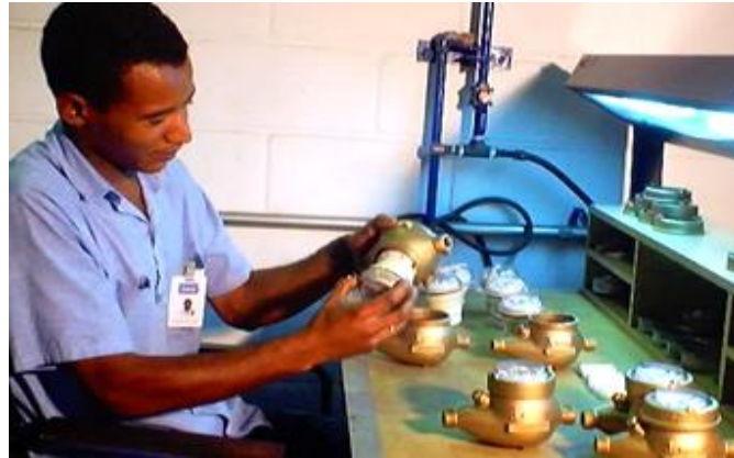
Figura 4.52: Bancada de montagem da carcaça de hidrômetro com Kit de medição
