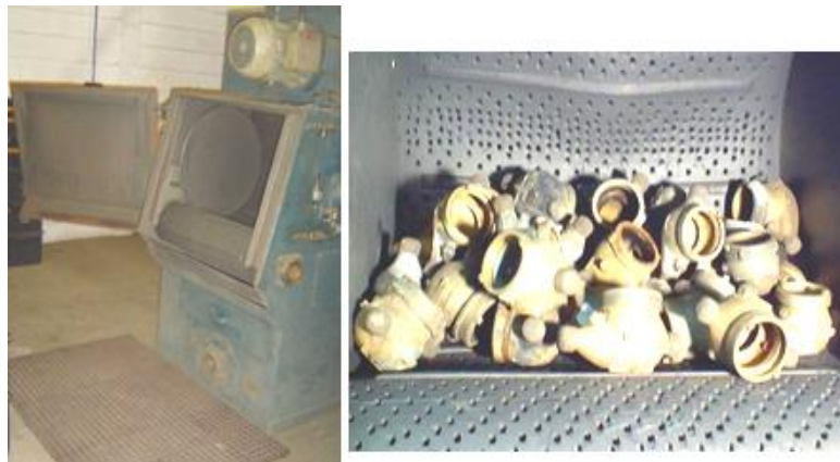
Figura 4.19: Máquina de jateamento de carcaças
