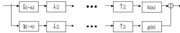
Figura 6.1: Diagrama em blocos do algoritmo de decomposição e síntese da TWD biortogonal [24].
