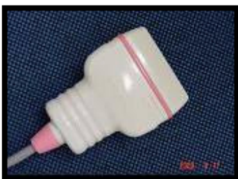
Figura 6 – Transdutor linear de 56 mm (capítulo 2)
