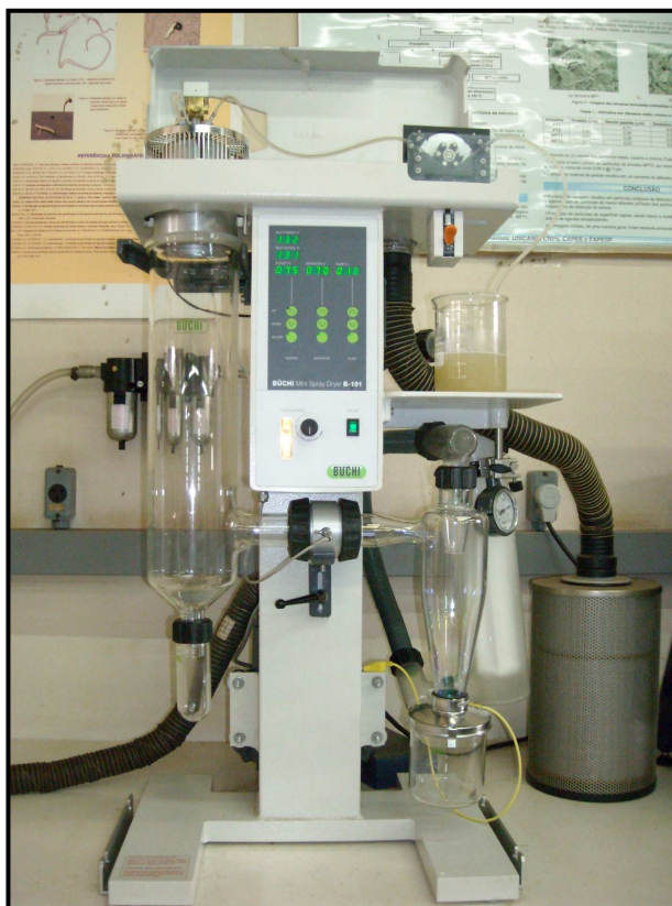
Figura 4.2: Spray dryer laboratorial, marca BÜCHI, modelo B-191, utilizado nos ensaios de secagem por atomização.
