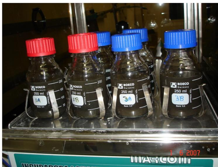
Figura 4.3: Frascos Duran com amostras na incubadora durante ensaio cinético
