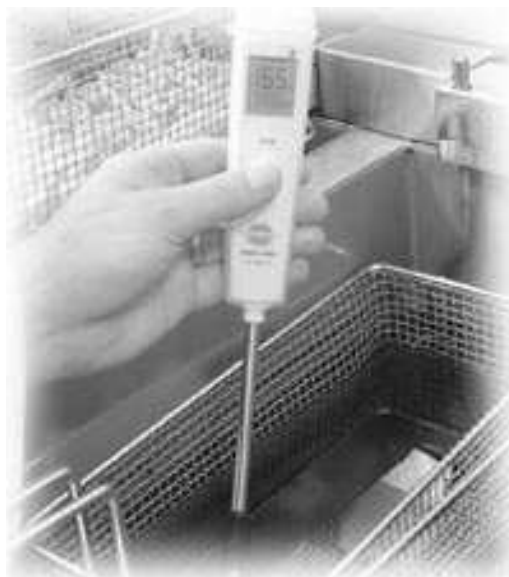
Figura 2. Monitoramento “in situ” da qualidade de óleos de fritura com o Testo 265.
