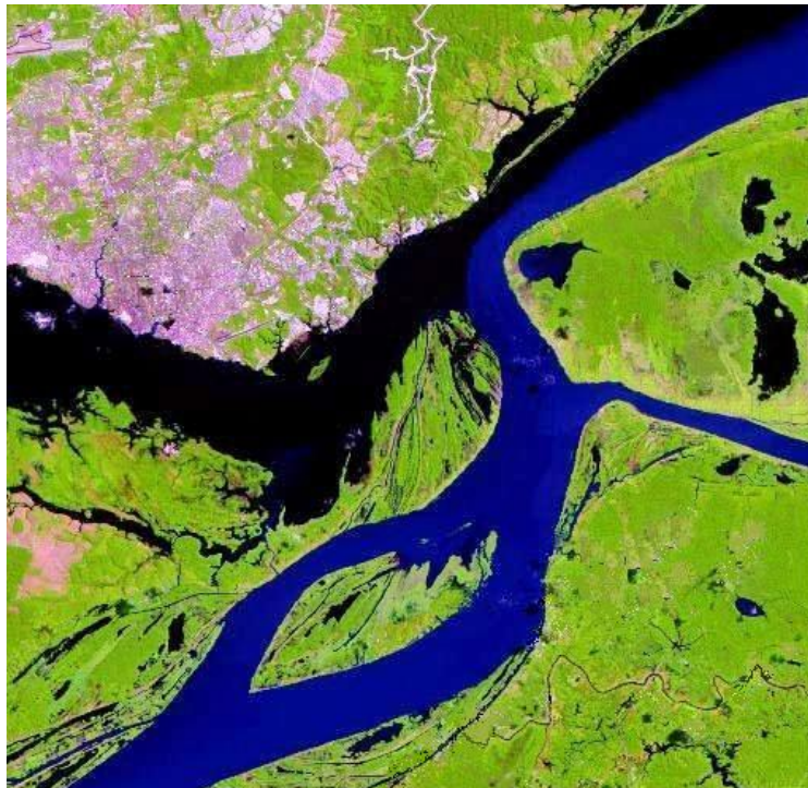
Fig. 4.13: Composição colorida das bandas 3(R), 4(G) e 5(B) da imagem teste.
