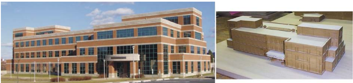
Figura 5.3: Edifício Leonhard na Universidade Penn State, EUA e sua réplica em LOM Fonte: http://www.me.psu.edu/lamancusa/rapidpro/examples/case_jebuild.htm
