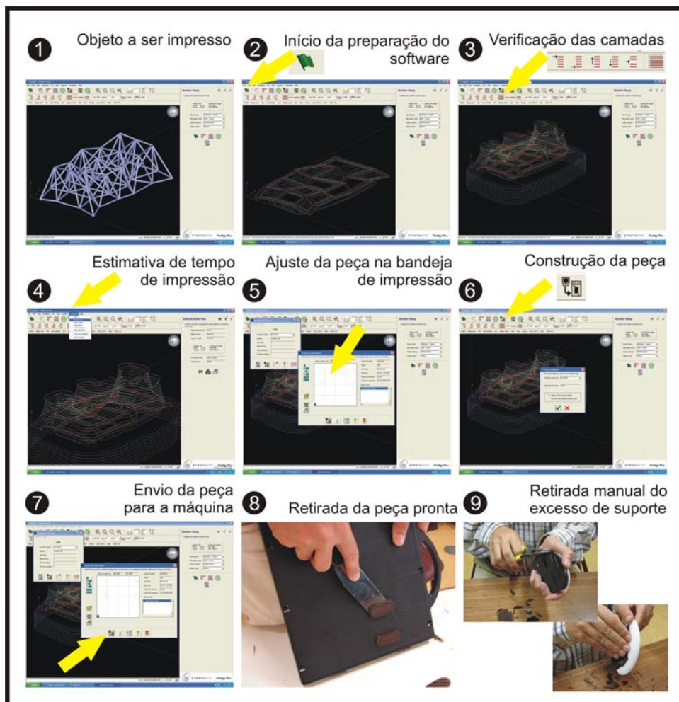
Figura 2.46: Interface software INSIGHT para equipamento Stratasys Prodigy Plus Fotos: Regiane Pupo
