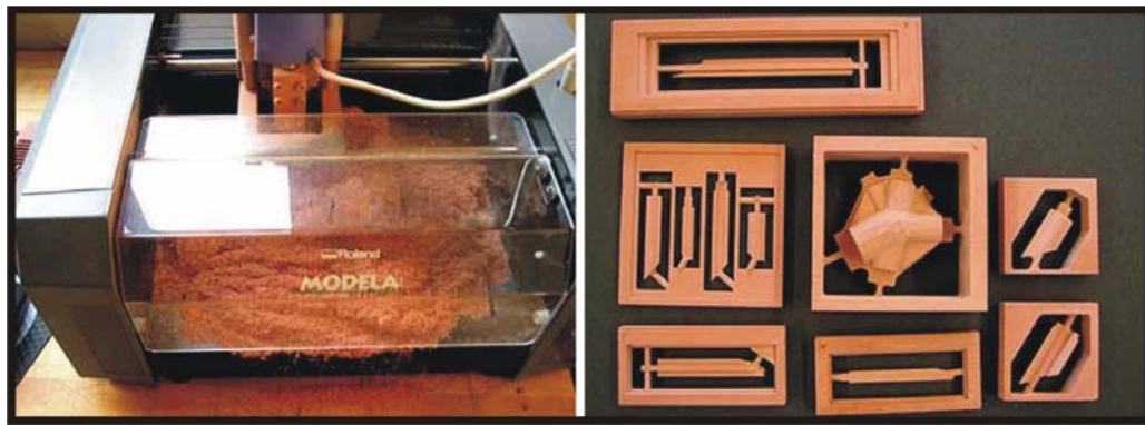
Figura 2.78: Fresadora Modela Miller com exemplos de aplicação em madeira Fonte: Digital Design Fabrication Group, 2006 ( www.ddf.mit )
