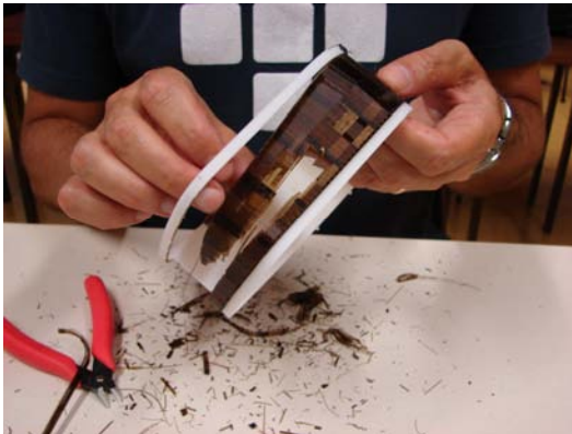
Figura 2.47: Retirada do material de suporte manualmente Foto: Regiane Pupo
