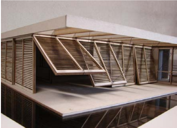
Figura 2.34: Maquete produzida em cortadora laser em MDF e balsa. IST- Instituto Superior Técnico de Lisboa, 2007
