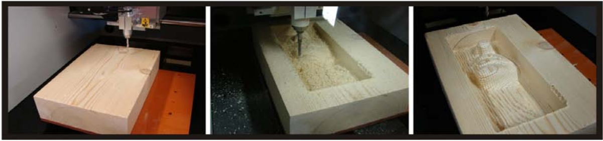
Figura 2.28: Método de produção em duas dimensões e meia (2.5 D) Fotos: Regiane Pupo
