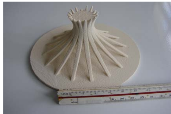
Figura 6.6: Peça prototipada em gesso – ZCorp 310 Alunos: Izabella Maciel e Renan Torricelli Foto: Regiane Pupo
