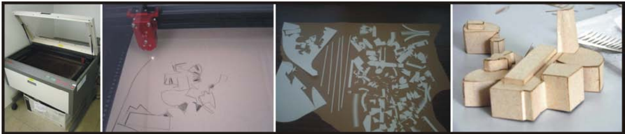
Figura 2.27: Trabalho em cortadora a laser Fonte: Vieira (2007)
