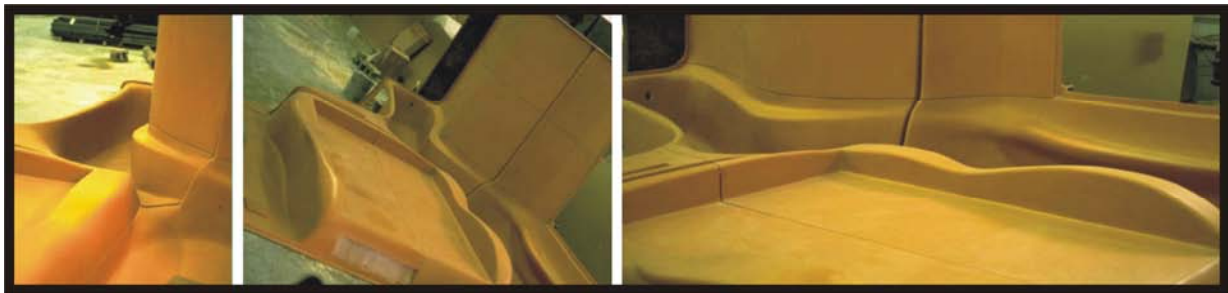
Figura 2.91: Projeto de interiores produzido com CNC – peças sem acabamento Fonte: Kolatan/Mac Donald Studio, Nova York, EUA http://www.moma.org/exhibitions/1999/un-privatehouse/project_17.html
