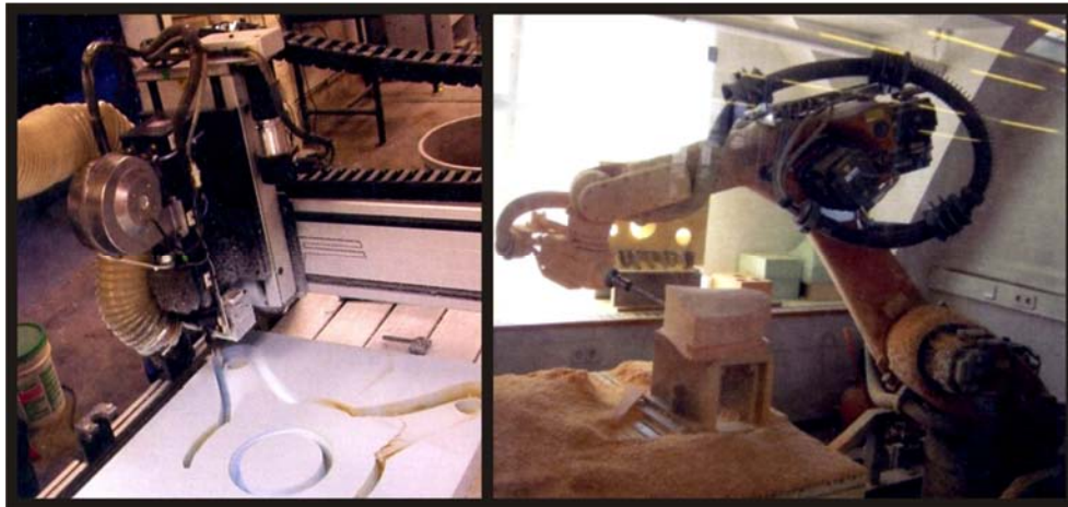
Figura 2.32: Desbaste de material em uma direção (esquerda) e em vários eixos (direita) Fonte: Pottmann at al (2007 p. 588)
