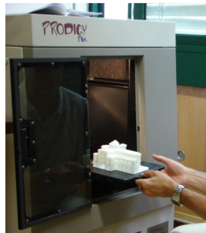
Figura 2.30: Produção direta 3D, de maquete, em equipamento Stratasys ProdigyPlus IST – Instituto Superior Técnico de Lisboa Foto: Regiane Pupo (2007)
