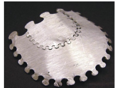
Figura 2.38: Exemplo de objeto metálico cortado com a cortadora a jato de água Fonte: Vieira (2007, p. 39)
