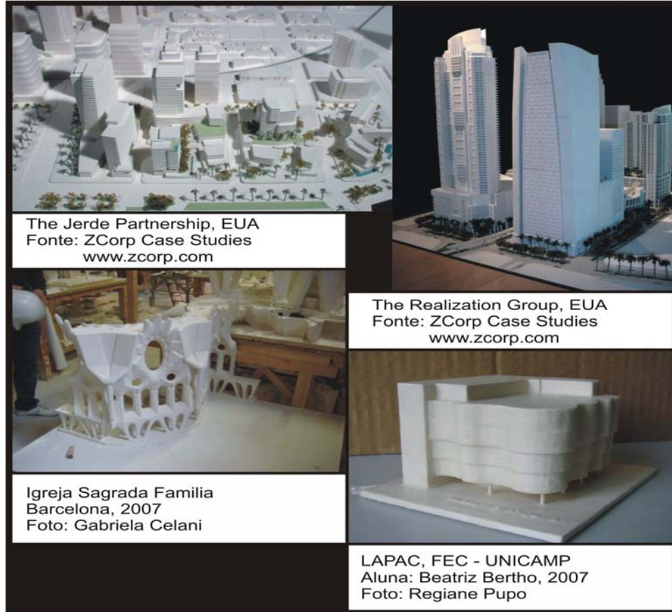
Figura 2.62: alguns exemplos de impressão em 3DP Fontes: indicadas
