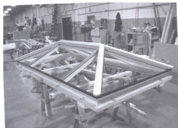
Figura 2.8: Montagem prévia das peças em CNC Fonte: Schodek (2005, p. 344)
