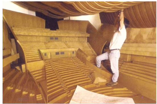
Figura 2.81: Maquete Disney Concert Hall (1998) para testes acústicos (escala 1:10) Fonte: Kolarevic (2003, p. 107)
