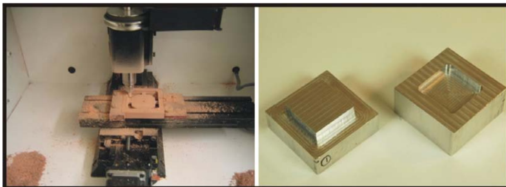
Figura 2.79: Fresadora Denford Miller com exemplos de aplicação em metal Fonte: Digital Design Fabrication Group, 2006 ( www.ddf.mit )
