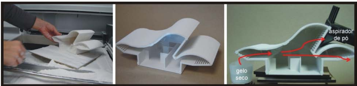
Figura 2.15: Estudo de túnel de vento com protótipo executado na impressora 3D Fotos: Regiane Pupo
