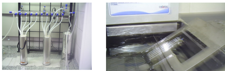
Figura 2a e 2b: Congelamento das ampolas e ampolas em banho de óleo aquecido (reação de polimerização), respectivamente.
