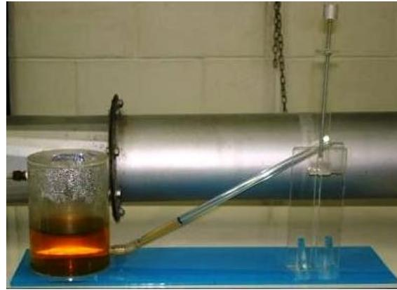
Figura 3.11 – Manômetro inclinado para determinação da queda de pressão
