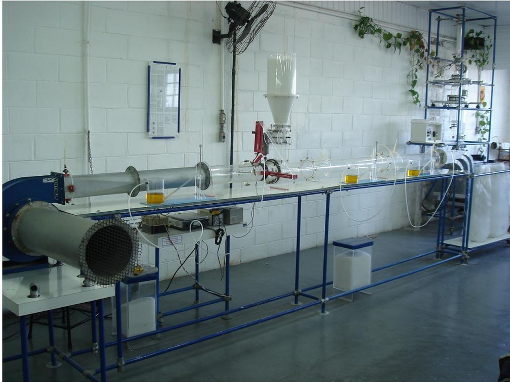
Figura 3.2 – Unidade piloto de transporte pneumático horizontal em fluxo diluído
