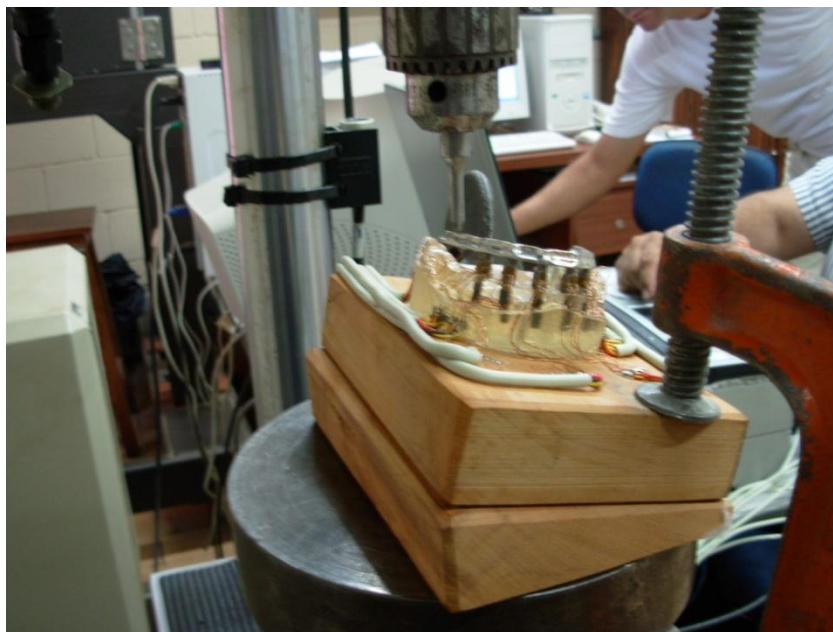
Fig. 15 – Modelo experimental fixado na célula de carga da máquina de ensaios MTS com 20° de inclinação.
