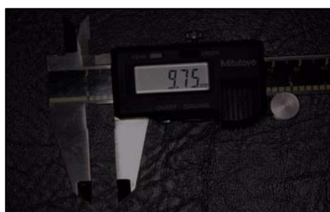
Fig. 4: distância medida pelo espaçador digital e quantificado pelo paquímetro digital.
