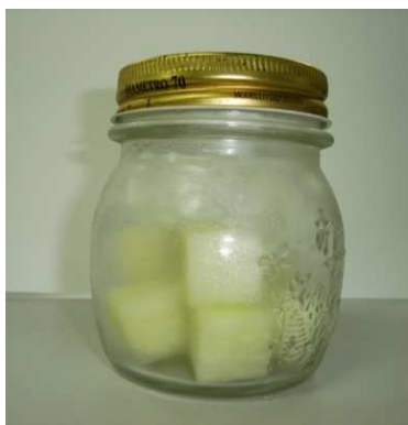
Figura 3.4: Recipiente hermético utilizado nos ensaios para determinação da taxa respiratória.
