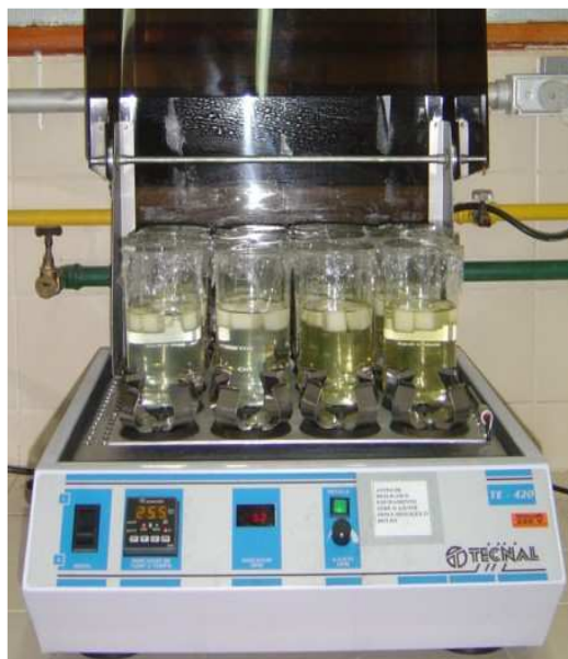
Figura 3.2: Banho termostático utilizado nos experimentos deste trabalho.
