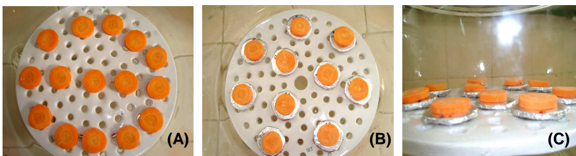
Figura 3.6. Etapas da análise de resistência à difusão do vapor de água: (A) amostras em um dessecador mantido a 98,2%UR, (B) e (C) amostras sob suporte em dessecador mantido a 33,3%UR.
