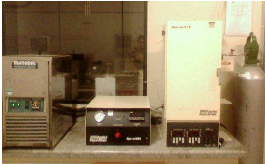
Figura 3.5. Unidade de extração supercrítica Spe-ed SFE
