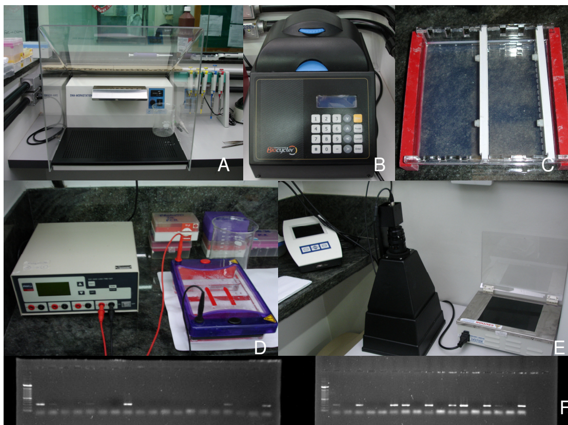
Figura 5- Processamento das amostras pelo método de PCR. A-Estação de trabalho para reações de PCR; B-Termociclador; C-Gel de agarose na cuba; D-Sistema de eletroforese; E-Sistema de imagens para leitura dos géis; F- Imagem dos géis após a corrente para análise.
