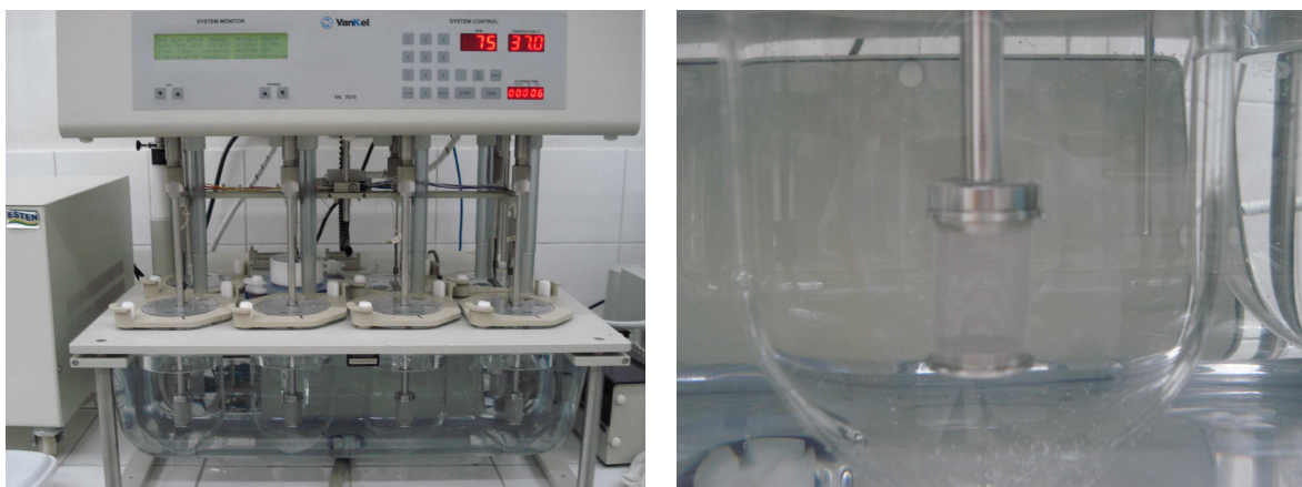
Figura 4.6. Dissolutor (a); aparato I (b).
