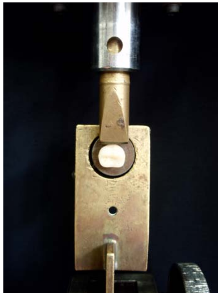
Figura 11. Posicionamento do corpo-de-prova no dispositivo para a realização do teste de cisalhamento.
