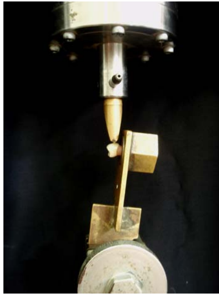
Figura 10. Dispositivo de suporte para o corpo-de-prova durante o ensaio de resistência ao cisalhamento.
