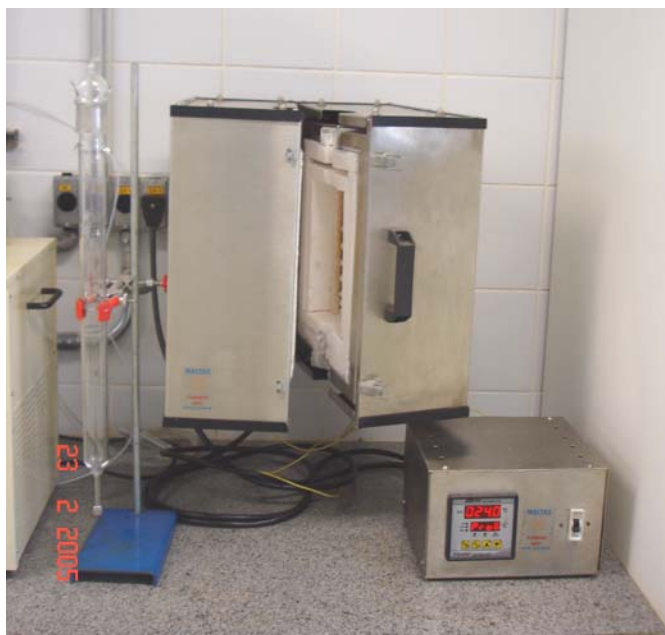
Figura 3.2: Equipamento usado para tratamento térmico.
