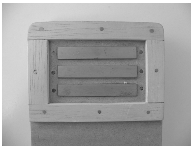
Figura 3. Dispositivo para confecção do molde em silicone das matrizes metálicas.
