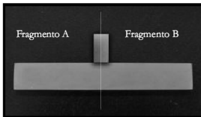
Figura 6. Fragmentos resultantes do teste de resistência ao impacto, para a análise microscópica. Demonstração da posição da imagem observada na lupa estereoscópica.
