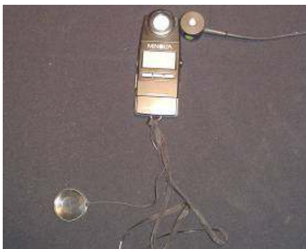
Figura 20: Medição simultânea dos sensores do Luxímetro Minolta T-10 e BABUC-M.
