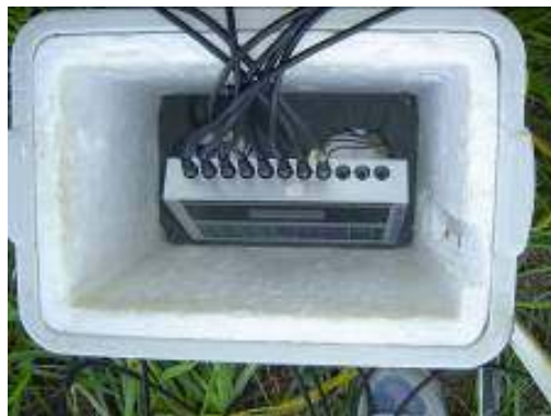
Figura 38 - Proteção do aparelho registrador, posicionado no interior de uma caixa isolante.
