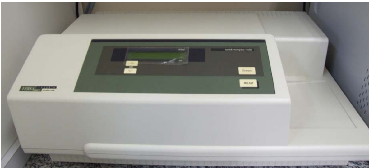
Figura 1. Leitor automático de microplacas utilizado para determinação da concentração de cálcio e fósforo.
