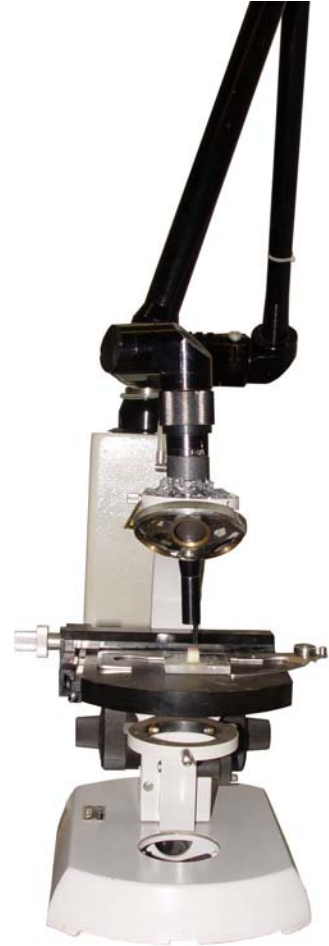
Figura 2. Laser de CO 2 acoplado ao microscópio para varredura da área de esmalte.
