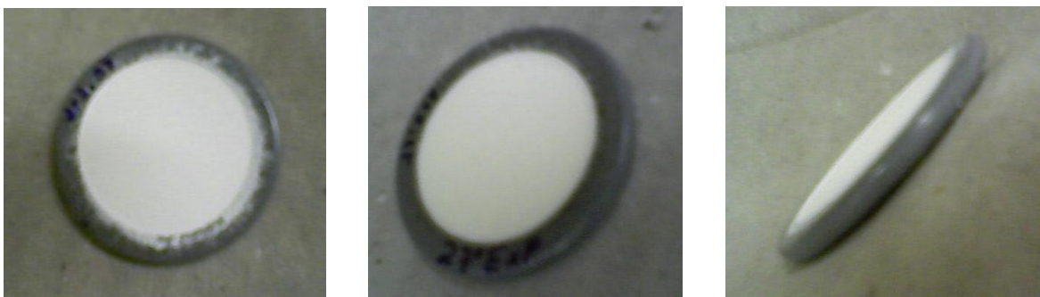
Figura 3.9 – Pó prensado em formato de disco para análise no espectrofotômetro de fluorescência de raios X.
