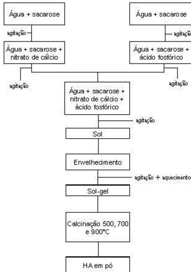
Figura 3.3 - Fluxograma da síntese da hidroxiapatita sintetizada pelo método sol-gel com sacarose.
