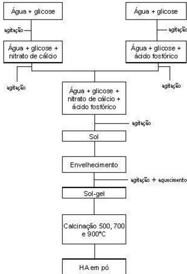
Figura 3.5 - Fluxograma da HA sintetizada pelo método sol-gel com adição de glicose.
