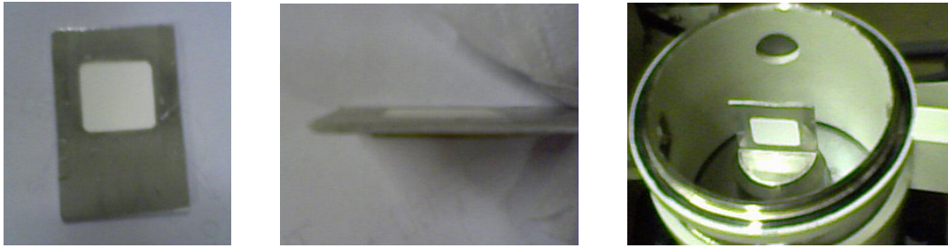
Figura 3.8 – Pó prensado levemente no porta amostra, que na seqüência se apresenta fixo no goniômetro do difratômetro de raios X.
