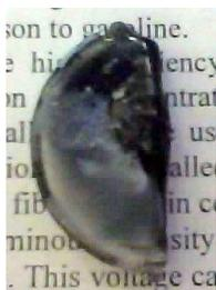
Figura 4.14. Amostra ST049-IT tratada termicamente acima de 1600 °C.
