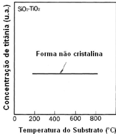
Figura 2.4. Diagrama de fase do sistema SiO<sub>2</sub>-TiO<sub>2</sub> [EDAHIRO et al., 1980].
