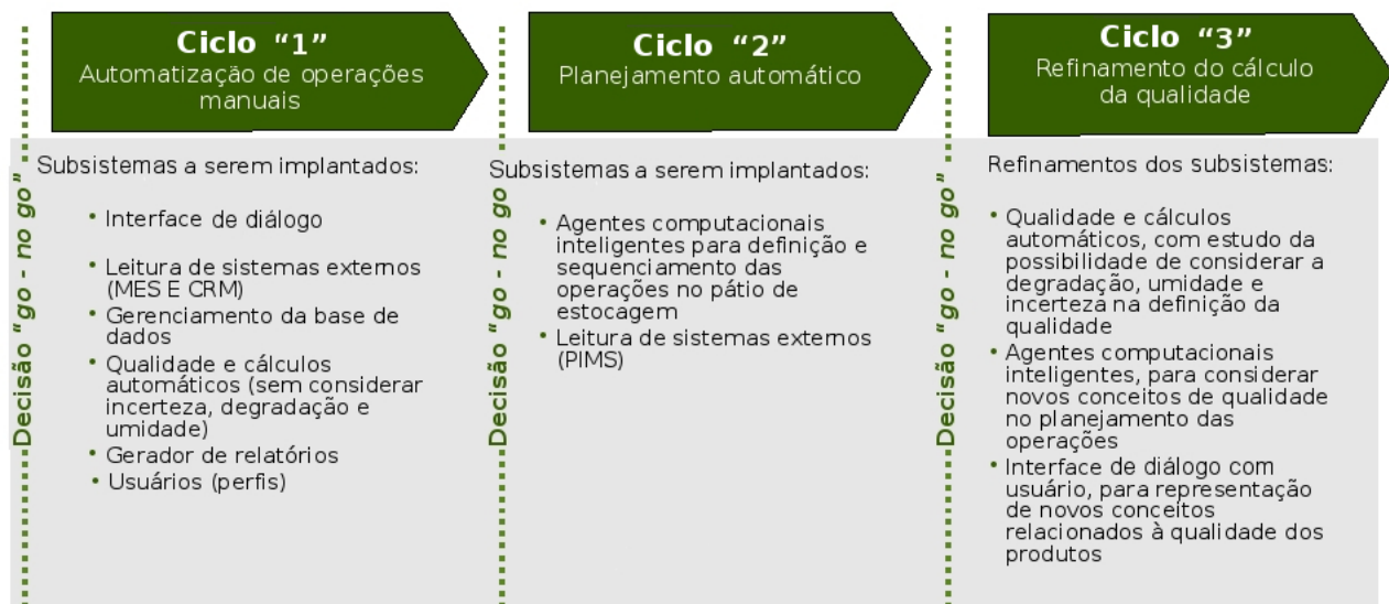
Fig. 7.40: Etapas do plano de ciclos de desenvolvimento do software
