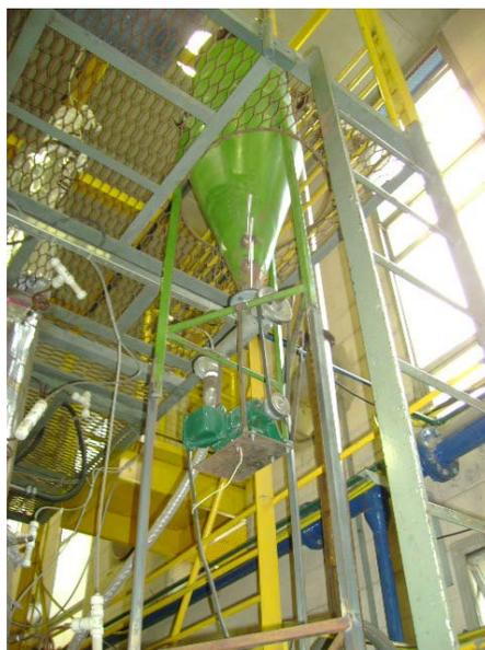
**Figura 3-8** Montagem da rosca dosadora no silo.
