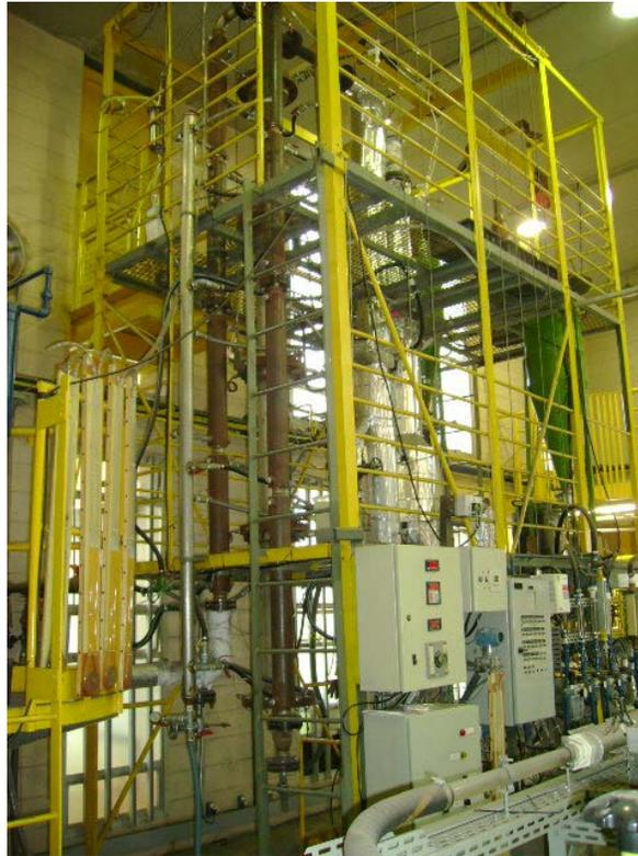
**Figura 3-1** Combustor de leito fluidizado circulante.
