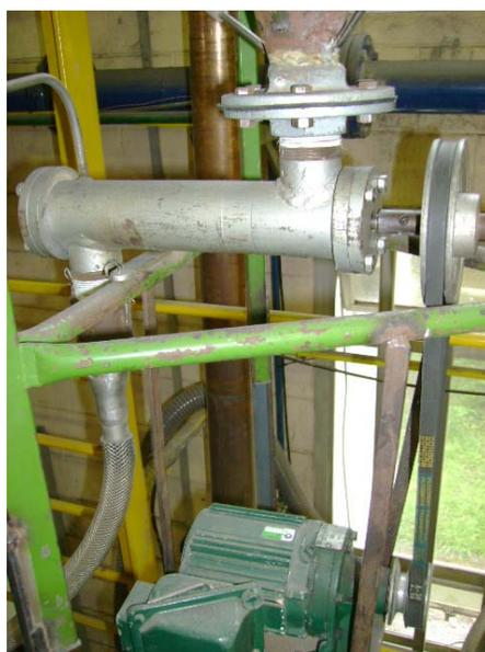
**Figura 3-9** Detalhe da rosca dosadora com seu acionamento e transmissão.
