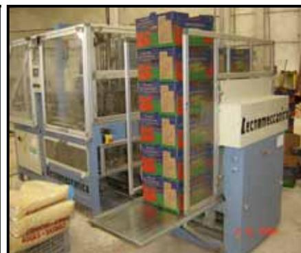
**Figura 46 – Montadora de caixas de papelão**
