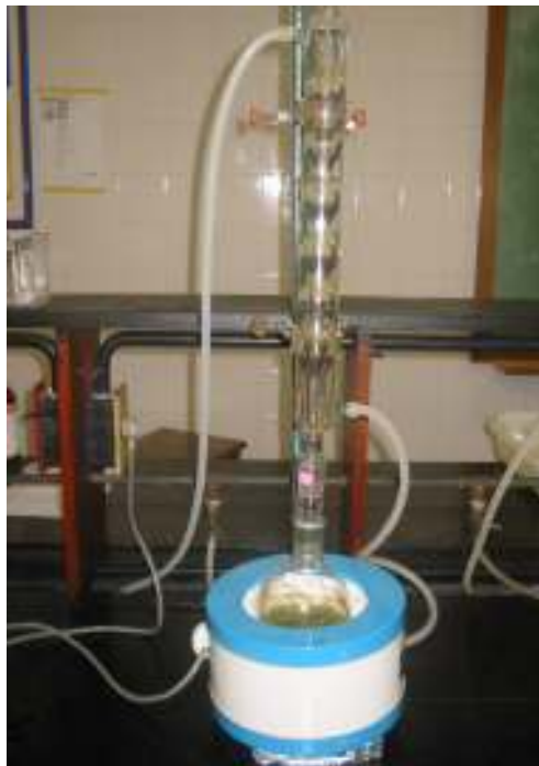
Figura 3.1 – Montagem experimental para a extração por refluxo de solvente
