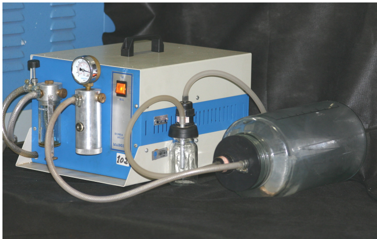
Figura 9 - Bomba a vácuo (esquerda), ligada à câmara para vácuo (direita)
