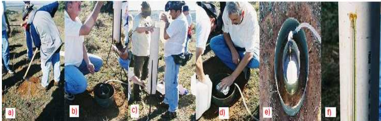
Figura 4.16 – Etapas de realização do teste de infiltração por método dos cilindros concêntricos. Fotos de: Cristiano Capellani Quaresma e Dr. Archimedes Perez Filho (orientador).
