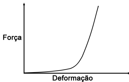
Fig. 2.3: Relação entre força e deformação da pele, adaptada de Skalak e Chien (1987)
