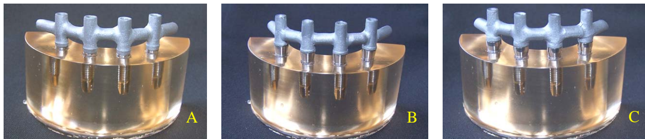
Figura 9: Estruturas metálicas fundidas em monobloco e posicionadas sobre seus respectivos pilares no modelo fotoelástico: (A) estrutura I obtida a partir de pilares Ucla, (B) estrutura II posicionada sobre pilares Esteticone, (C) estrutura III posicionada sobre pilares Microunit.
