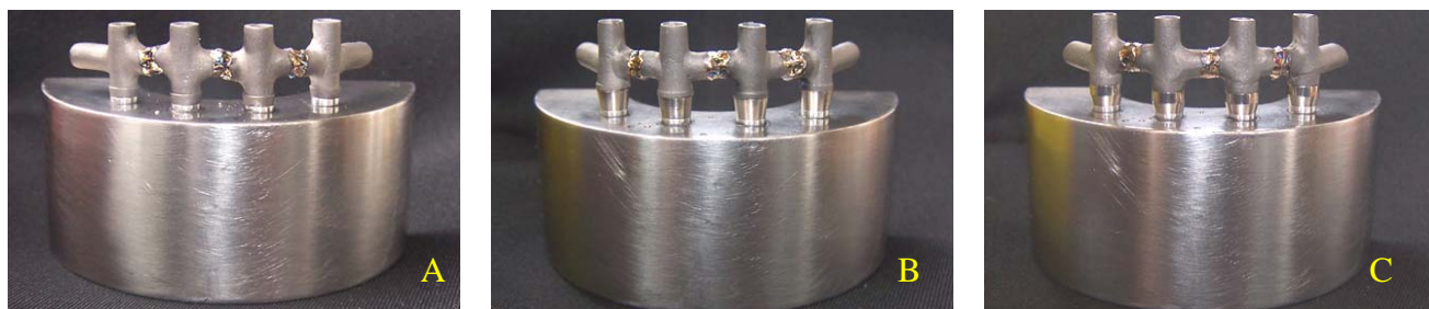
Figura 11: Estruturas metálicas posicionada sobre seus respectivos pilares na matriz metálica onde foram submetidas à soldagem vertical a laser: (A) estrutura I obtida a partir de pilares UCLA, (B) estrutura II posicionada sobre pilares esteticon, (C) estrutura III posicionada sobre pilares microunit.
