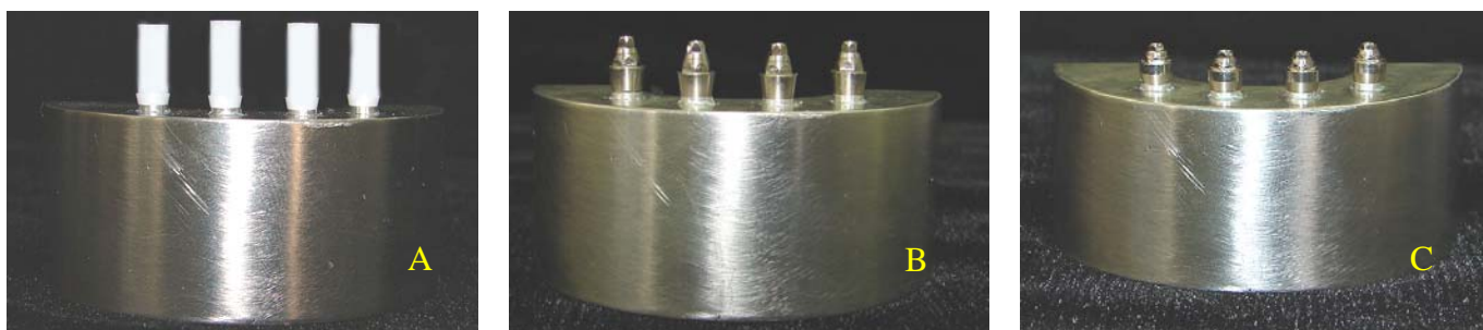
Figura 7: Pilares Ucla (A), pilares esteticone (B) e pilares microunit (C) utilizados respectivamente para as estruturas I, II e III.
