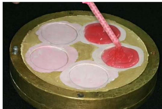
Figura 8b – Inserção do material
