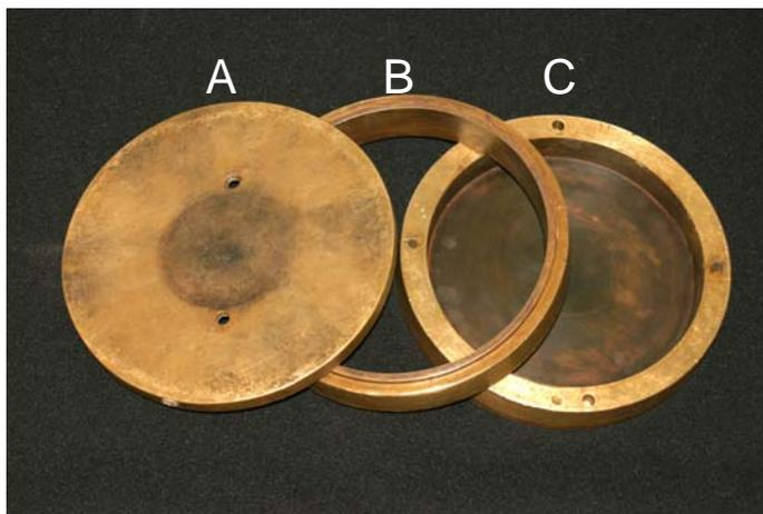
Figura 3 – Mufla metálica (A – tampa; B - contra-mufla; C - mufla)
