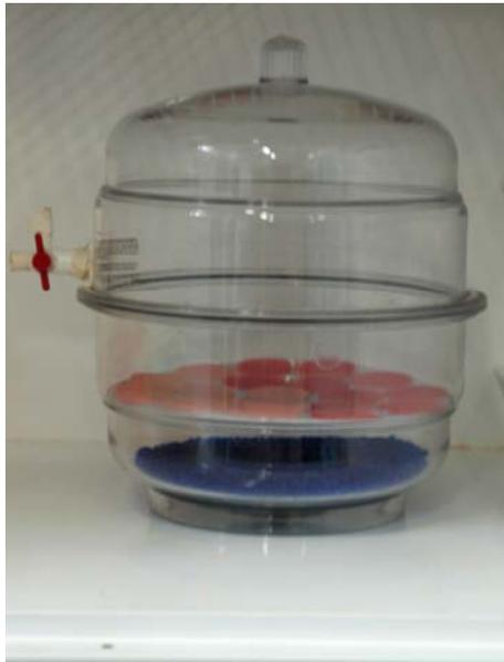
Figura 10 – Dessecador contendo amostras e sílica gel
