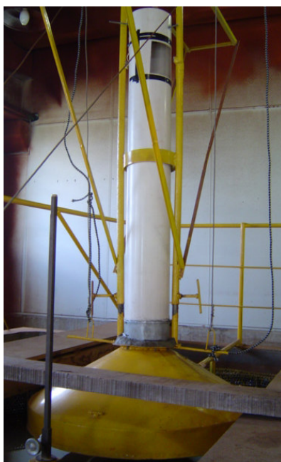
Foto 6.3 Campânula utilizada para medir o ar.
