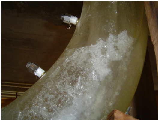
Foto 7.3 Deflexão do escoamento na curva C2 para Q/Q_0 = 0,8 .
