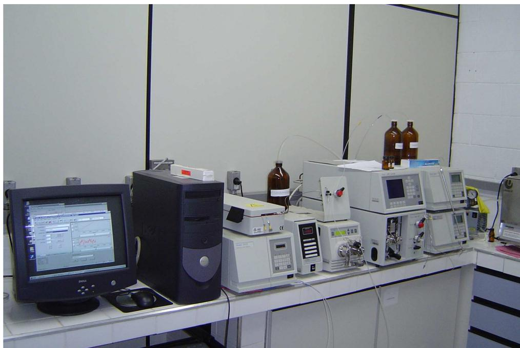
Figura 4.3: Unidade de análise por CLAE, com os três detectores ao fundo e a bomba de alimentação
